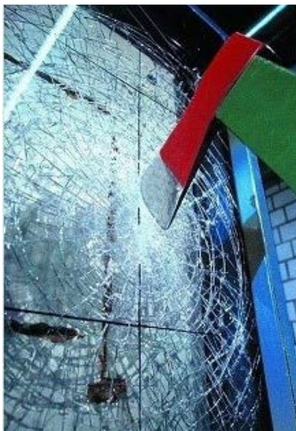
FIGURA 10. PROVA DI RESISTENZA ALL'ATTACCO DI MAZZA E ASCIA
